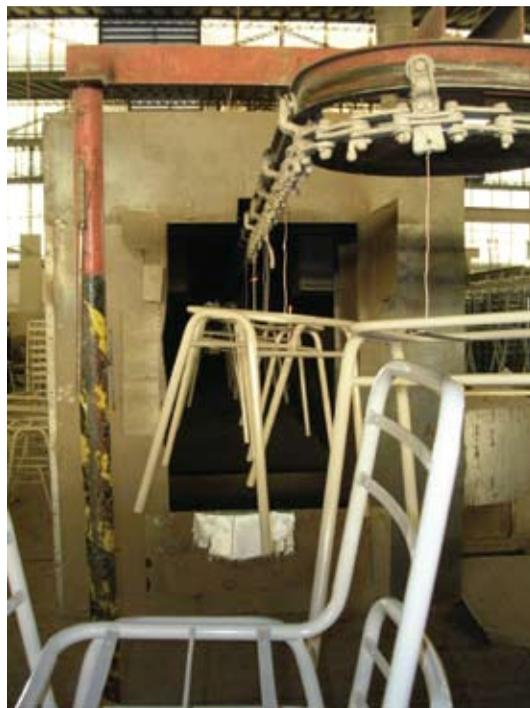
Las sillas ingresan al horno de pintura, que funciona con los residuos que genera la propia industria, ahorrando energía y evitando contaminación ambiental.
