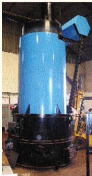
**Caldera tipo humo-tubular vertical.** Presión de trabajo: 4 kg/cm<sup>2</sup>. Temperatura del fluido térmico: 270°C. Superficie de caldeo: 40 m<sup>2</sup>. Transferencia térmica: 1.000.000 kcal/h.
